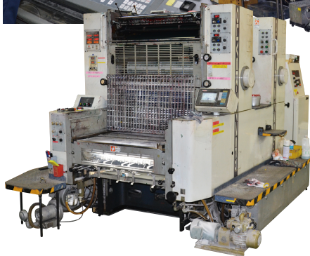
桜井機械 OL 272EPII 反転印刷対応(同時両面印刷) 2色機 1c/1cまで対応
